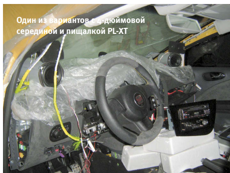
Окончательное решение: СЧ на отражение
