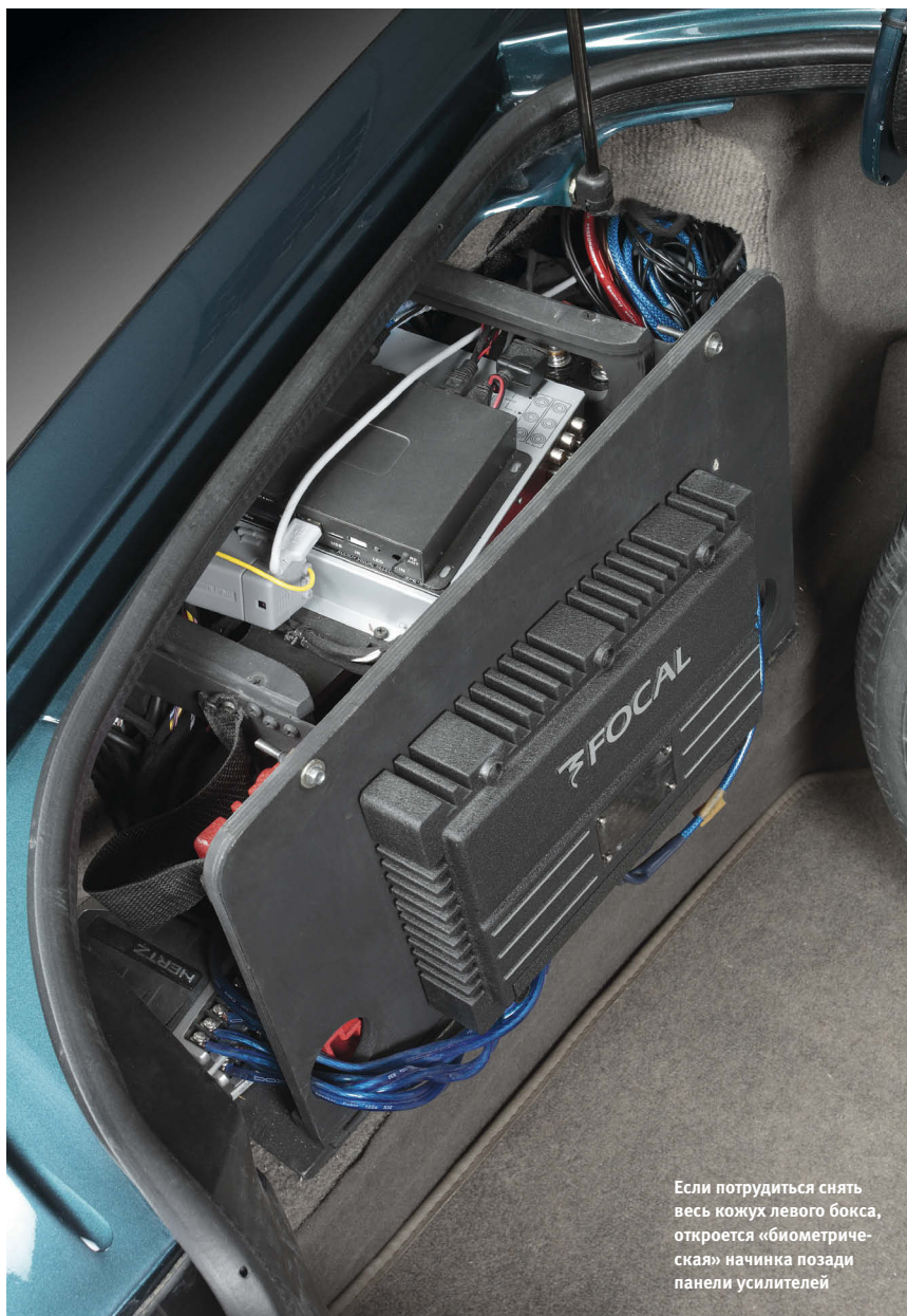
При снятых защитных сетках видно: слева — один из усилителей...
