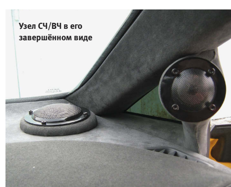
Благодаря причудливой форме подиум ВЧ не загромождает треугольное стекло
